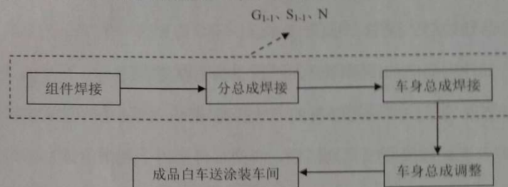
图 2-4 焊接车间生产工艺流程及产污环节图
